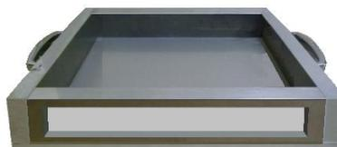
アルミ製標準型枠 (内寸 : 300×300×50 mm)
